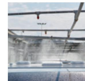
Test di impermeabilizzazione contro le infiltrazioni al 100% dei veicoli usciti di produzione, prima della consegna.
